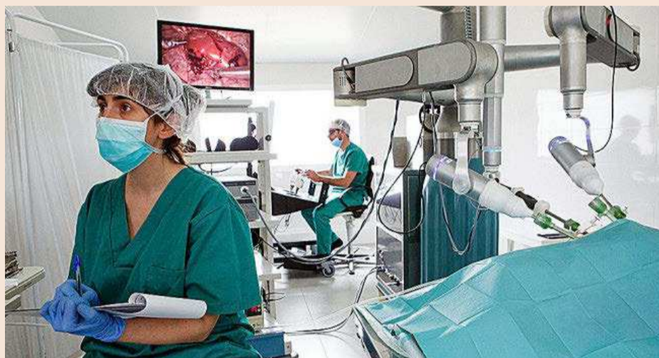
El robot Bitrack cuenta con cuatro brazos articulados para realizar las intervenciones.
